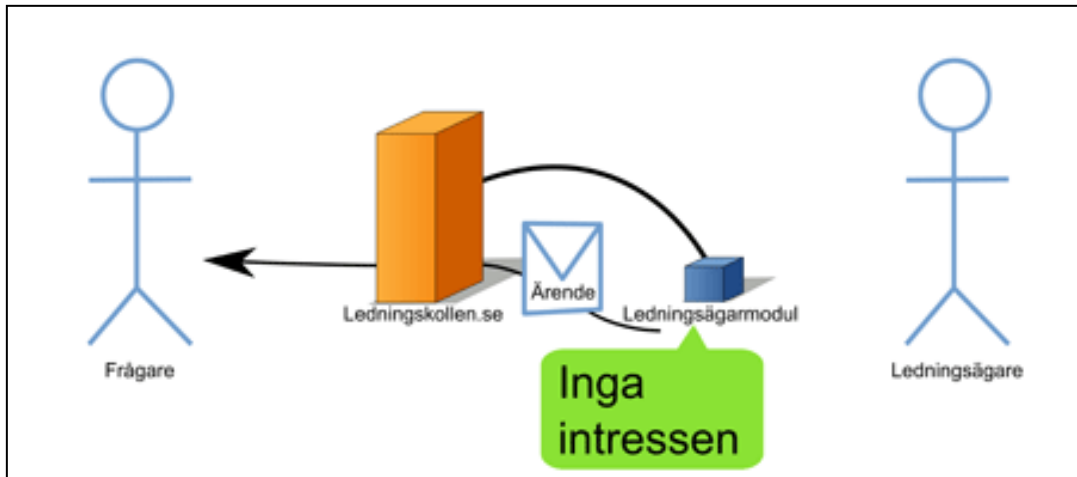
Bild 2. Ledningsägarmodulen hämtar ärendet från Ledningskollen och kontrollerar ärendet direkt mot ledningsägarens aktuella nätutsträckning i detta fallet fanns inga intressen i närheten varvid Ledningsägarmodul återrapporterar detta till Ledningskollen.
